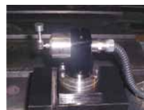
Sonda pro nastavení délky a detekci zlomeného nástroje (volitelné příslušenství)
