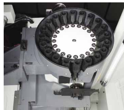
Bubnový zásobník nástrojů pro 20 pozic s výměnnou rukou zvládne výměnu už za 1,2 sekundy.
