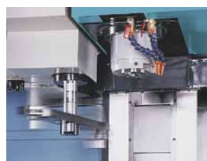
Automatický bubnový zásobník nástrojů s výměnnou rukou ideálně omezuje střet mezi nástroji a obrobkem na minimum. Kapacita může být volitelně zvětšena až na 48 pozic.
