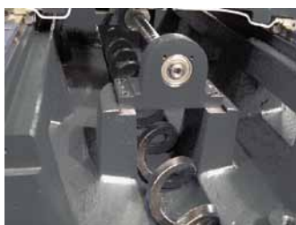
Stroje mohou být vybaveny šroub pro odstraňování třísek - šroub odvádí třísky do prostoru vynašeče.
