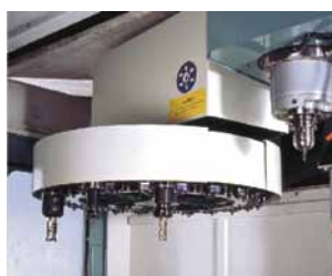
Automatický zásobník nástrojů je možné zvolit buď karuselový nebo bubnový s výměnnou rukou. Oba typy výměny nástroj velmi rychle.
