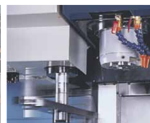
Automatický zásobník nástrojů je možné zvolit buď karuselový nebo bubnový s výměnnou rukou. Oba typy výměny nástroj velmi rychle.
